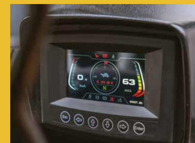
O instrumento de tela colorida multifuncional fornece informações importantes da empilhadeira.
