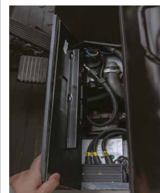
Placa de piso removível sem ferramentas para fácil manutenção do motor de acionamento e DCDC, etc.
