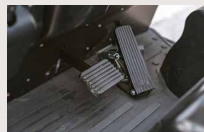
O sistema de frenagem de deslocamento conta com frenagem hidráulica combinada com frenagem em piso molhado, proporcionando proteção de camada dupla.
